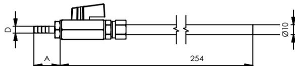
VALVOLA SEZIONAMENTO PER PENSILI CON ATTACCO RAPIDO Ø 3 mm; Ø 4 mm
